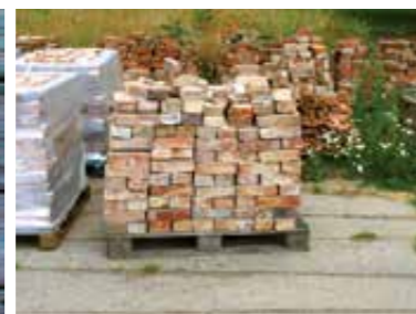
Recycelte Ziegel sind Speicher „grauer Energie“
