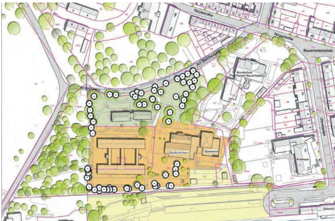
Abbildung 12 Darstellung aus Entwurf B-Plan Nr. 30 mit Flächen für Verkehr, Bebauung, Grün, zu erhaltenden Bäumen
